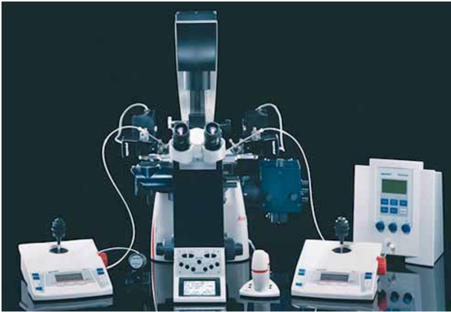
Abb. 1: Instrumentelle Ausrüstung: Inverses Digital-Mikroskop, Leica AM6000 mit Mikromanipulatoren, Eppendorf Öl-Injektoren zur Spermien-Injektion und Heizplatte für optimale Wärmeversorgung der Eizellen
